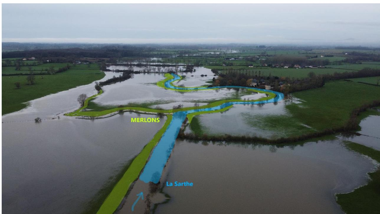
Figure 2 : Illustration des effets des merlons sur les crues
