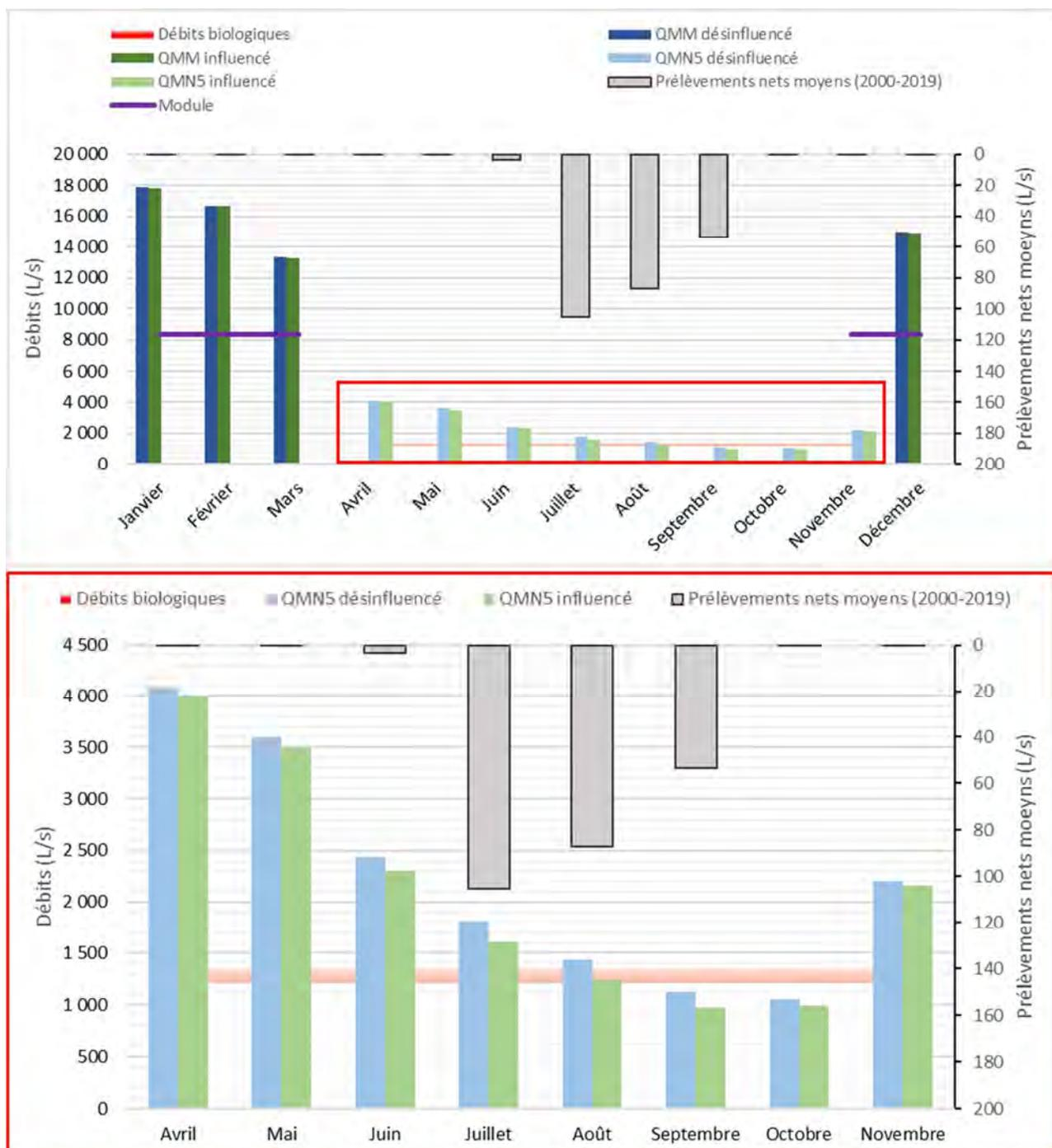
Figure 10 : Mise en perspective de l'hydrologie influencée et désinfluencée avec les besoins des milieux et les usages moyens (sur l'ensemble du bassin drainé) sur la période 2000-2019<sup>910</sup> – Sarthe amont
