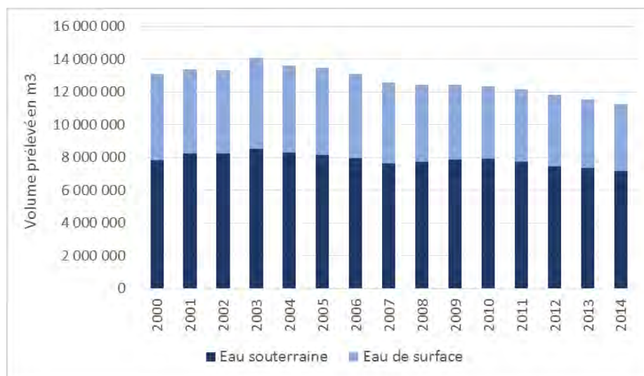
Figure 2-1 : Volumes prélevés pour l'eau potable sur le bassin versant de la Sarthe aval en fonction de l'origine de l'eau
